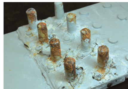
图14 舰载机连接密封失效腐蚀
