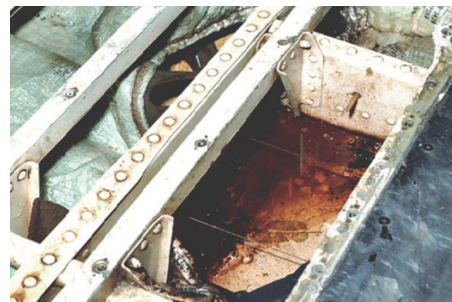
图13 水上飞机机身船底漏水
